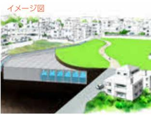
首里石嶺町4丁目地区の浸水被害軽減を目的として、地下貯留式雨水調整池の設置工事を進めています。
