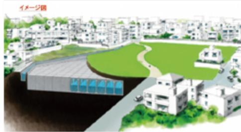
首里石嶺町4丁目地区の浸水被害軽減を目的として、地下貯留式雨水調整池の設置工事を進めています。
