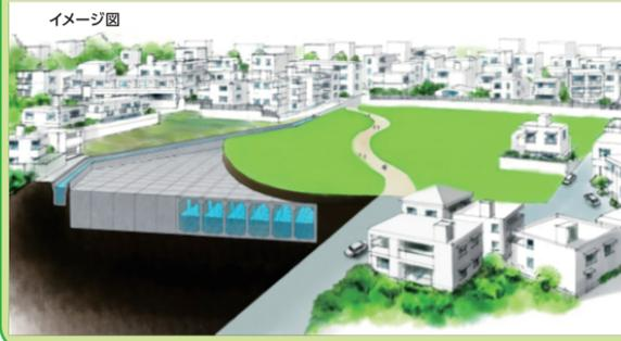
首里石嶺町4丁目地区の浸水被害軽減を目的として、地下貯留式雨水調整池の設置工事を着手しています。
