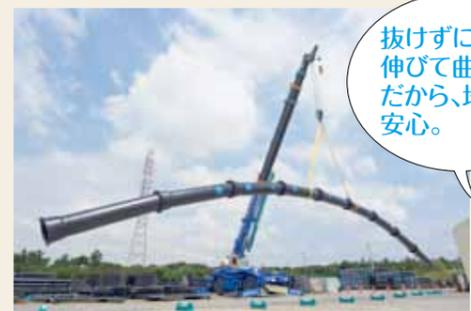
抜けずに伸びて曲がる!! だから、地震でも安心。
