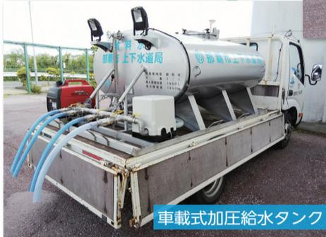
車載式加圧給水タンク
