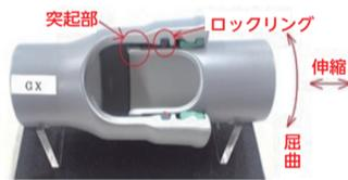
上下水道局では、地震などの災害時に陥没や亀裂などの地面に異常が起こった場合を想定して耐震管を使用しています。
