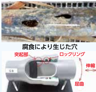
腐食により生じた穴 突起部 ロックリング 伸縮 屈曲 上下水道ともに更新の際は地震対策が必要となります。(上の写真は水道用耐震管です。)
