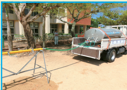
↑ 給水車による応急給水
