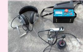
漏水探知機：音聴棒より正確に漏水音をとらえるための機械です。
