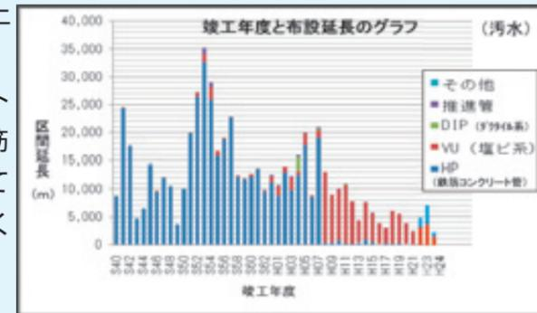
汚水から発生する硫化水素の影響を受け易い鉄筋コンクリート管は、約460kmであり全体の約80%を占めています。現在、鉄筋コンクリート管から腐食に強い塩化ビニル管への取替えを進めており、今後ますます取り替え工事(布設替え)の必要性が高まってくると予想されます。
