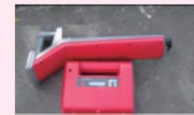
鉄管探知機：管に磁気を帯びさせ、埋設位置の探知を行うものです。
