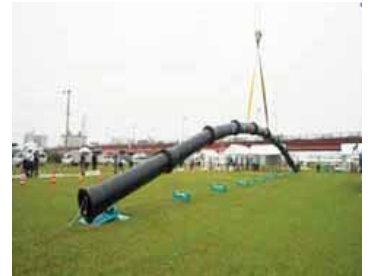
管のつなぎめが伸び縮みしたり、曲がったりと管が抜けにくい継ぎ手であるため写真のように吊り下げても外れません。
