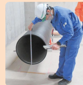
口径 600mm の配水本管
