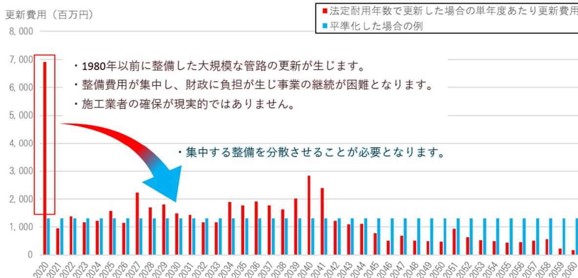
図 1-4 管路の更新を平準化するイメージ図
