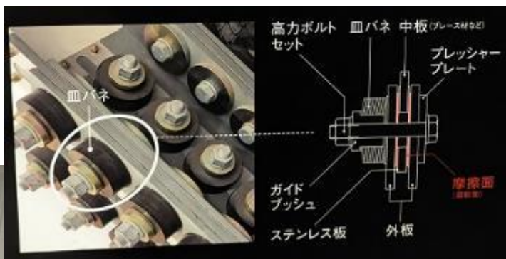
↑ ← 摩擦ダンパー 天守閣で採用した制振要素の一つである。大地震時にはプレート類が動くことで摩擦力が発生し、揺れのエネルギーを熱に変える。プレートは皿バネによって一定の力で締め付けられているため中小地震の揺れでは動かず、高い剛性で耐震性能を向上させる。
