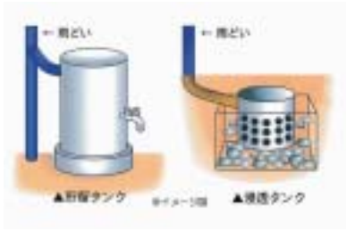
雨水貯留・浸透施設
