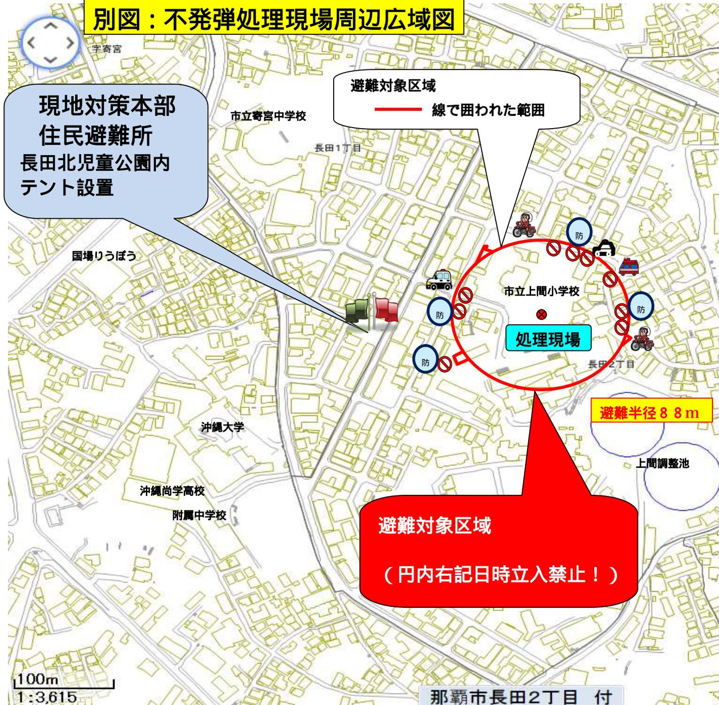
平成 28 年 4 月 25 日、長田 2 丁目の高齢者複合施設建築現場内で実施された同種弾処理の際は、径 3 m × 高 6 m の強固な防護壁（ライナープレート）を使用し、国の定める避難距離基準が 156 m でしたが、今回は、平成 28 年 9 月 1 日以降導入された径 2 m × 高さ 6 m のライナープレートを使用するため、避難半径が 88 m に縮小されております。
