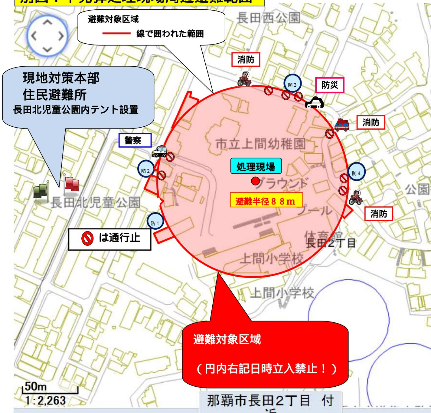
平成 28 年 4 月 25 日、長田 2 丁目の高齢者複合施設建築現場内で実施された同種弾処理の際は、径 3 m × 高 6 m の強固な防護壁（ライナープレート）を使用し、国の定める避難距離基準が 15.6 m でしたが、今回は、平成 28 年 9 月 1 日以降導入された径 2 m × 高さ 6 m のライナープレートを使用するため、**避難半径が 8.8 m に縮小**されております。
