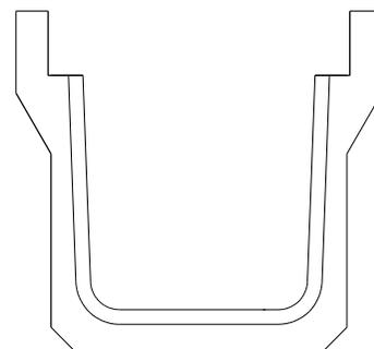
落蓋式側溝蓋 W350 × t 90 × L500
