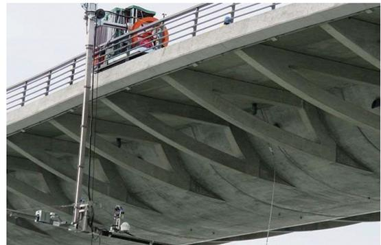
写真-2 橋梁点検支援ロボット
