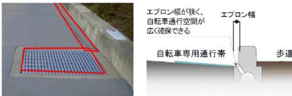
図 4-8 側溝の整備イメージ 格子間隔が狭く滑り止め加工された蓋の設置例（左）と設置イメージ（右）
