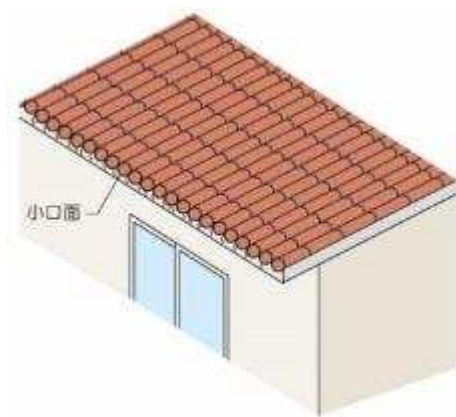
軒樋、雨樋がない場合
