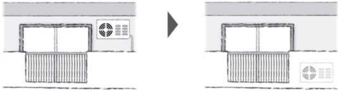
室外機は、周囲から視認されにくいよう配慮する
