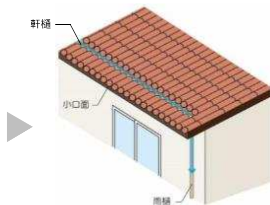
軒樋、雨樋がある場合
