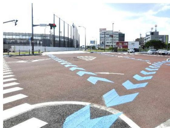
交差点部に矢羽根型の自転車専用の道路標示をした車道混在型の自転車通行空間の事例【名護市:宮里・21世紀の森公園付近】
