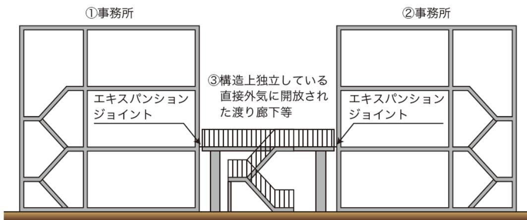
3棟の防火対象物として、消防用設備等を設置する。
