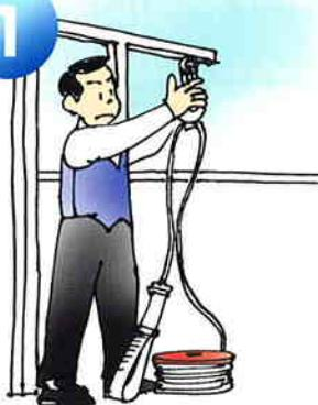
取付金具に調速器がしっかりと取り付けられているか確認します。
