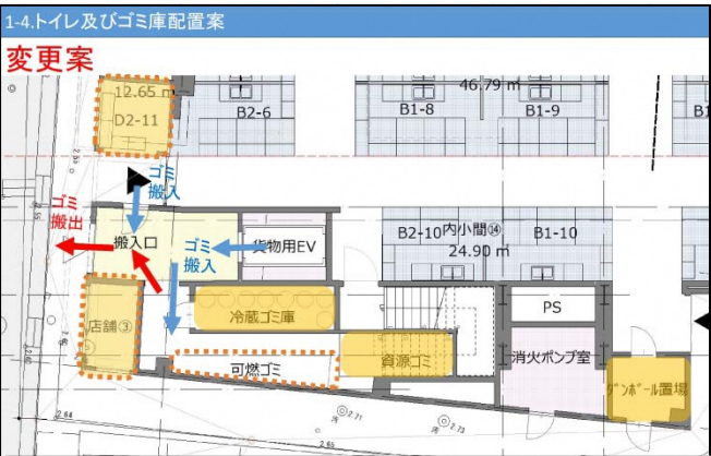
変更案 1階平面図(ゴミ庫部分拡大)
