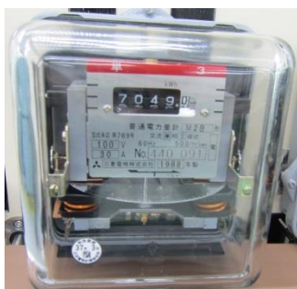
電気メーター
