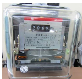
電気メーター
