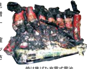
焼け焦げた充電式電池
