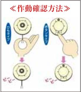
※住宅用火災警報器は電池が切れると作動しなくなり、定期的な点検ボタンを押すなどして作動確認を行いましょう。電池切れの目安は約10年です。
