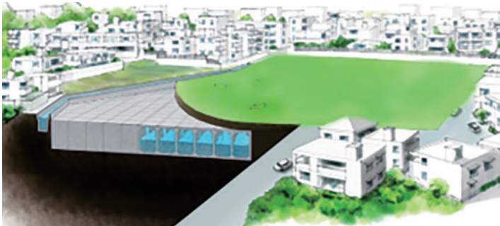
調整池内部の様子 ●貯留量約6,000m 3 (学校のプール16杯分相当)
