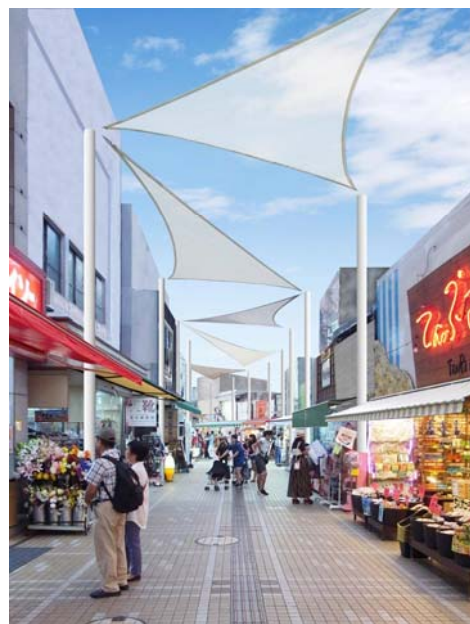
③-2 一部撤去・整備 （柱存置・上部日避け設置） ※屋根を撤去し、柱は工作物として使用。
