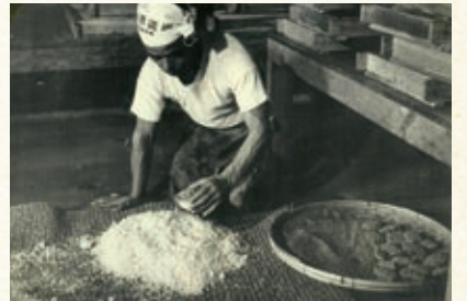
▲ニクブクの上で蒸された米に黒麹菌を混ぜ合わせる作業工程(沖縄県酒造組合提供)
