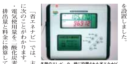
各階のエレベーター横に設置された省エネナビ
