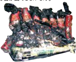
焼け焦げた充電式電池
