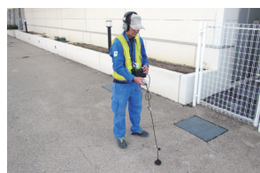
マイクで地面から音を拾う「漏水探知器」
