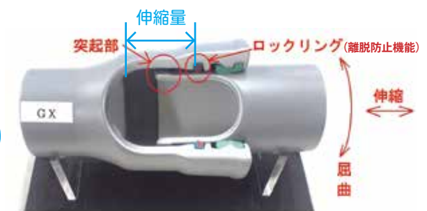
耐震管継手構造
