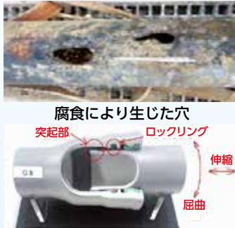
上下水道ともに更新の際は地震対策が必要となります。(上の写真は水道用耐震管です。)
