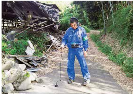
▲西原村での漏水調査
