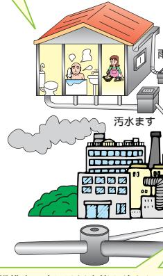
工場排水の中には污水管を詰まらせたり、損傷せたり、あるいは下水処理場に悪い影響を与えるものがあるので、このような障害を取り除くための施設です。
