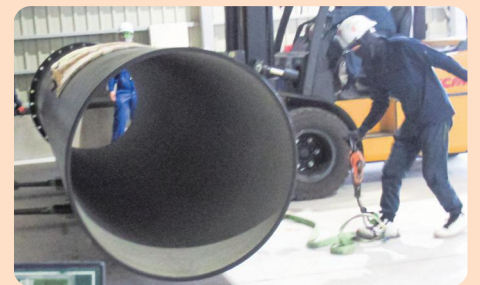
口径 1,200mm の送水管
