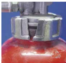
× キャップの破損
