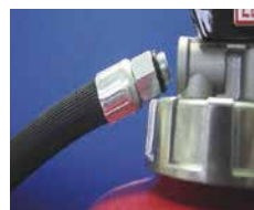
× 緊結ネジの破損 ホースの脱落
