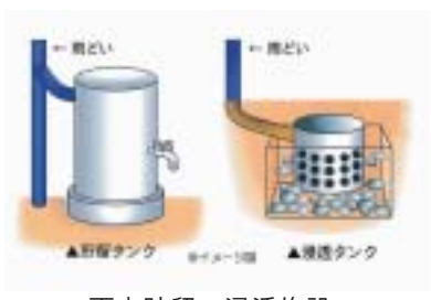
雨水貯留・浸透施設
