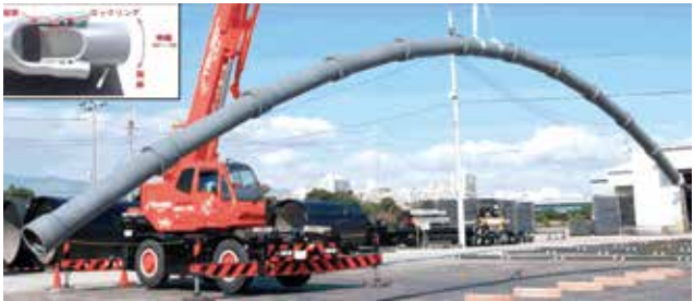
耐震型ダクタイル鉄管(屈曲・伸縮状況)
