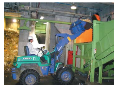
圧縮・こん包するための機械にペットボトルを入れます
