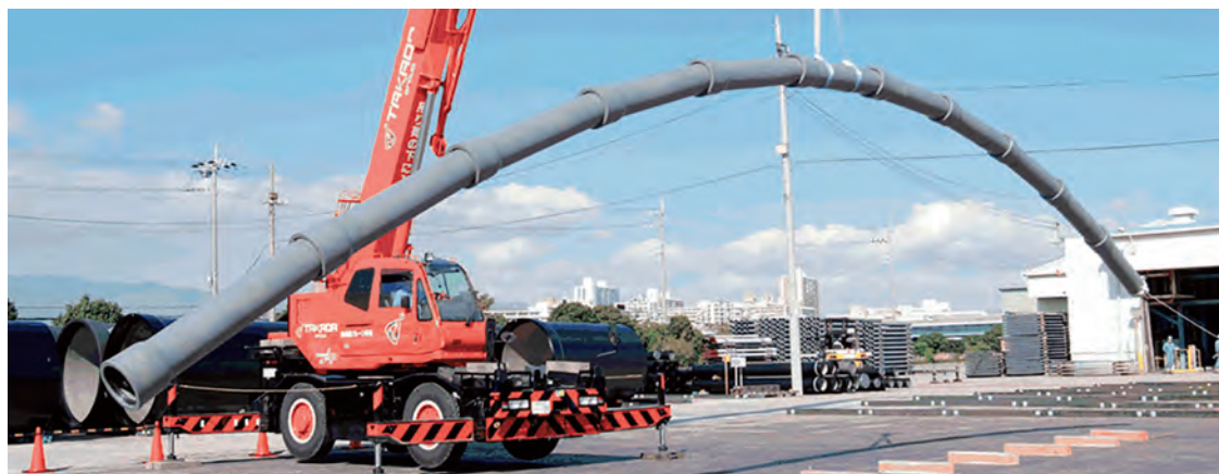
耐震型ダクタイル鋳鉄管 (日本ダクタイル鉄管協会提供)
