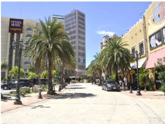
歩道との段差を解消するとともに、歩車道の舗装を一体的にデザインすることで、明るく楽しい空間を演出【北谷町:アメリカンビレッジ】
