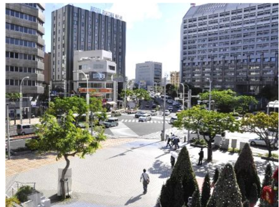
交差点の歩道部に広場を設けることで見通しの良い交差点を形成【那覇市：県庁北口交差点】
