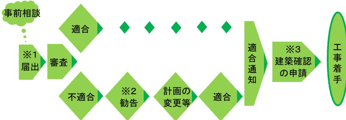
※1 工事着手の30日前までに届出をします。（A4サイズで2部提出します。）
